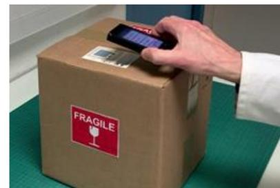
L'étiquette de capteur de choc intelligent fabriquée avec le matériau Piezotech® pourrait trouver de nombreuses utilisations à court terme :
