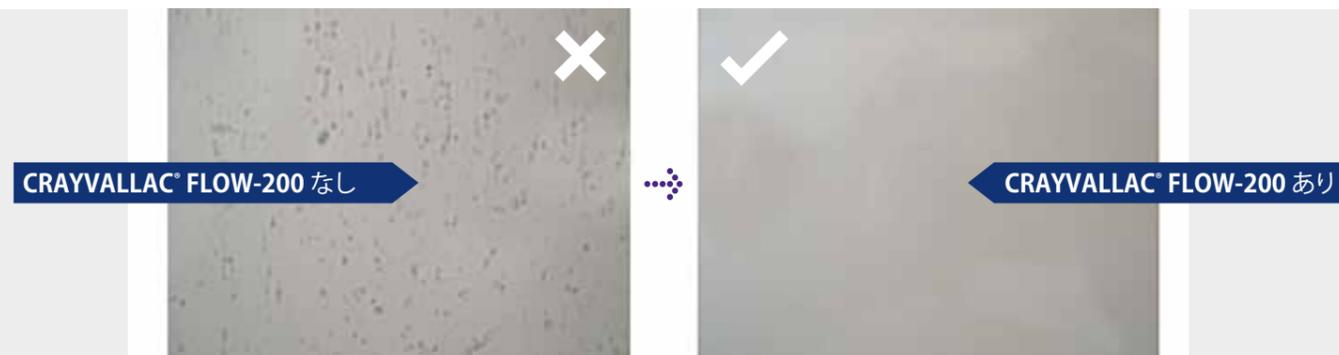
CRAYVALLAC® のレベリング助剤は、塗料表面の特性をコントロールするために性能を発揮します。ポリアクリレートとアクリル酸をベースにした製品は、右記のような効果をもたらします。
