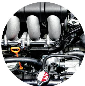
**11.** A sostituzione del metallo, i componenti del motore possono essere progettati in Rilsan® HT, una poliammide resistente alle alte temperature che riduce il peso del motore. Pesa:
